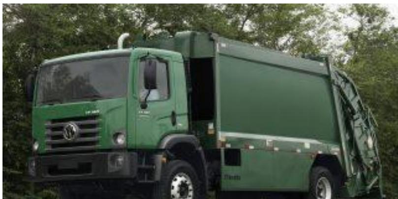
Figura 2 - Modelo de Caminhão Compactador de Resíduos (CCR) do tipo “toco”
